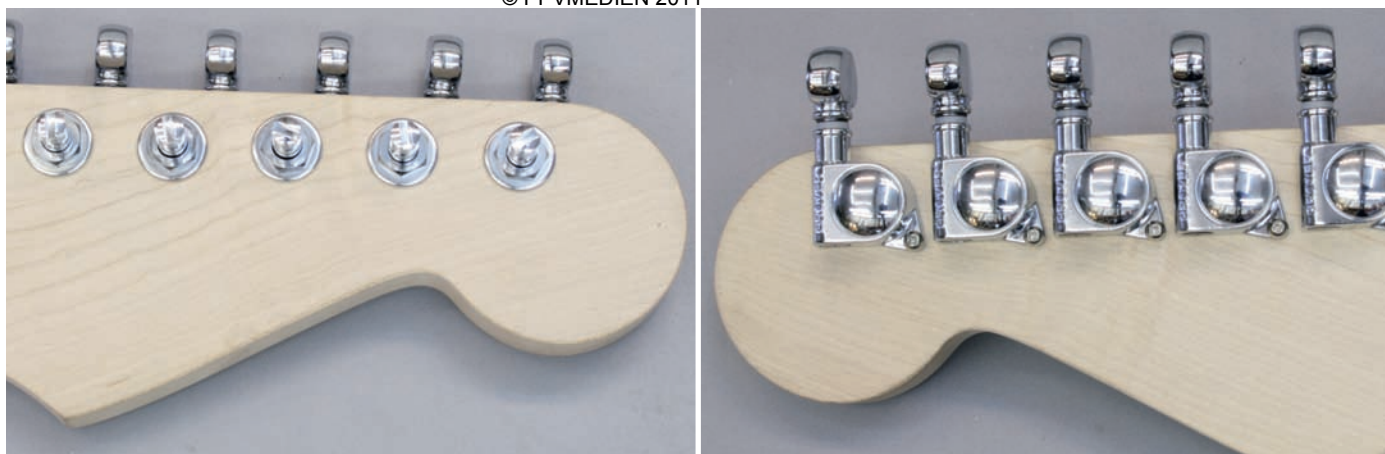
Abb. 14: Etappenziel erreicht – Stimmungsmacher montiert
