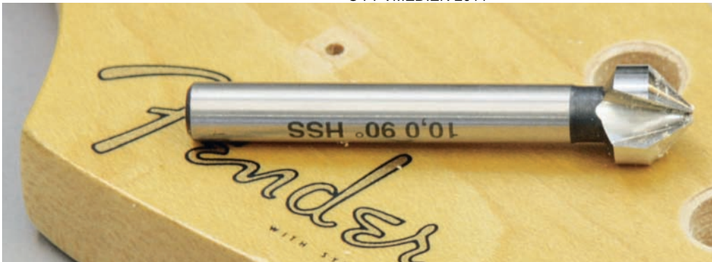
Abb. 6: Leichtes Aufkrausen des Loches: Dann flutscht es besser
