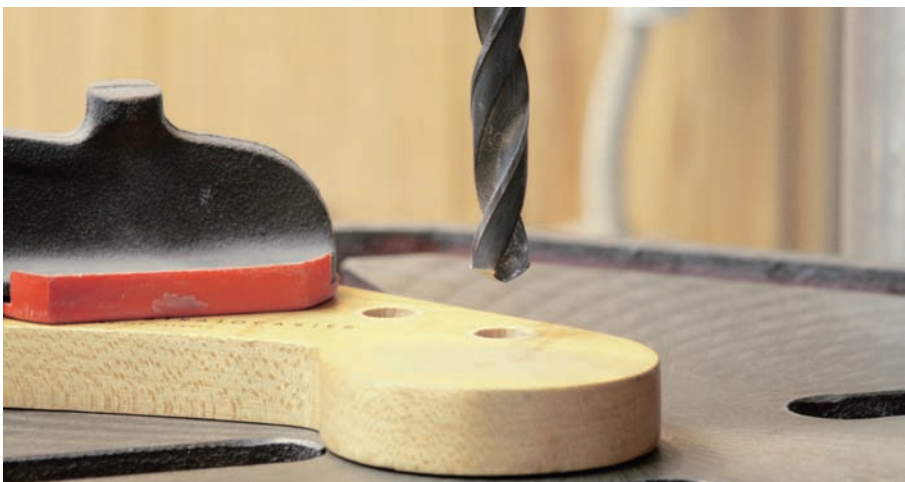
Abb. 5: Aufbohren der Befestigungslöcher
