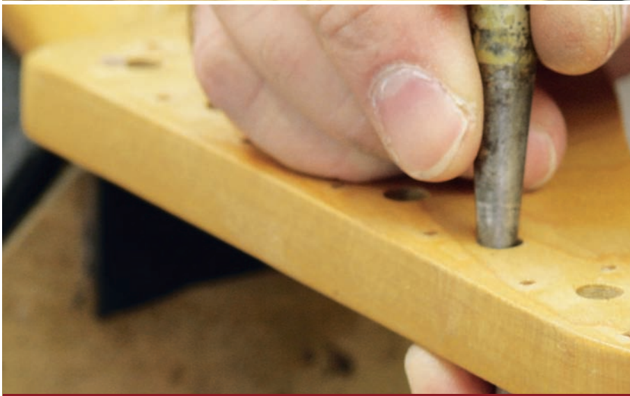
Abb. 4: Das Entfernen der alten Hülsen
