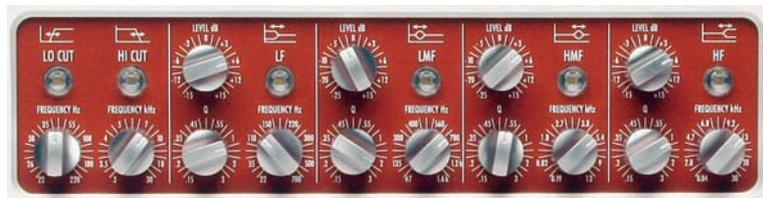
**Vollparametrischer 4-Band-Equalizer:** Neben Shelving- und Peak-Filtern finden sich beim Channel-Strip MindPrint En-Voice DTC auch steilflankige Low- sowie Hi-Cuts.
