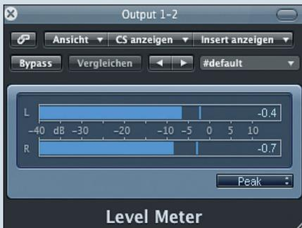
Zeigt den Pegel eines Signals an: Level Meter.
