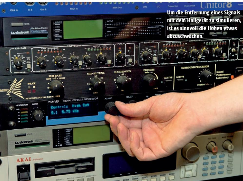
Um die Entfernung eines Signals mit dem Hallgerät zu simulieren, ist es sinnvoll die Höhen etwas abzuschwächen.
