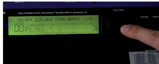
Einstellen der Delay-Zeit in einem Hardware-Delay-Gerät von Alesis: Das Gerät gibt komfortablerweise gleich an, bei welchem Songtempo die gewählte Anzahl Millisekunden der Länge eines 1/4-Taktes entspricht.
