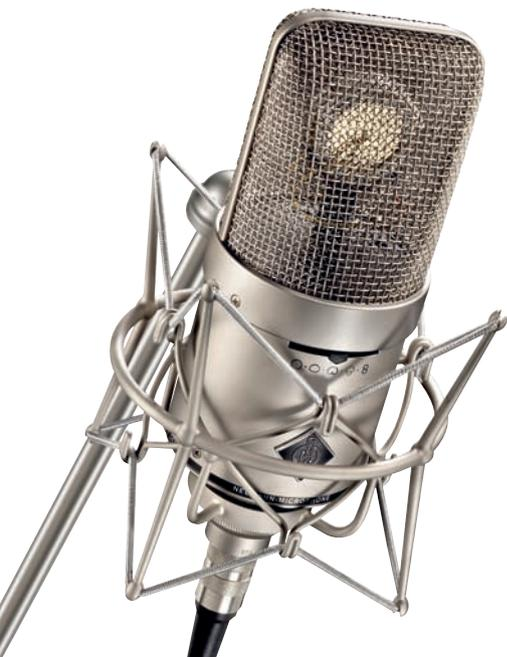
**Das Neumann M 149 Tube ist ein Röhrenmikrofon mit neun umschaltbaren Richtcharakteristiken (Kugel, breite Niere, Niere, Hyperniere und Acht mit jeweils einer Zwischenposition). Das Mikro muss über ein externes Netzteil betrieben werden, um die Röhrenschaltung mit der nötigen Spannung zu versorgen.**
