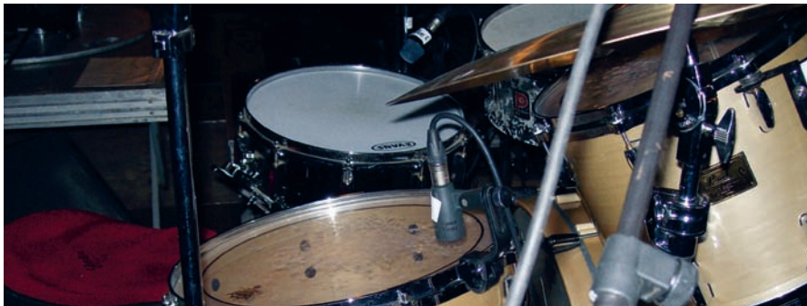
Clipmikrofone sind ideal für den Einsatz an den Toms und der Snare: Ihr spart euch dadurch Stative und kommt nahe an die einzelnen Instrumente ran ohne dem Schlagzeuger zu sehr in die Quere zu kommen.
