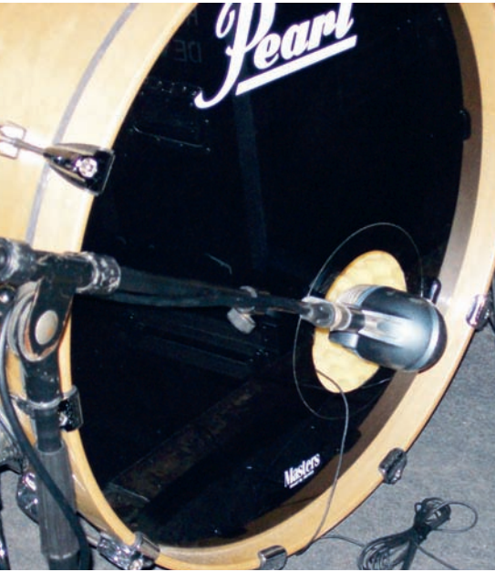
Für einen wuchtigen Bassdrumsound könnt ihr das Mikrofon am Resonanzloch ausrichten.
