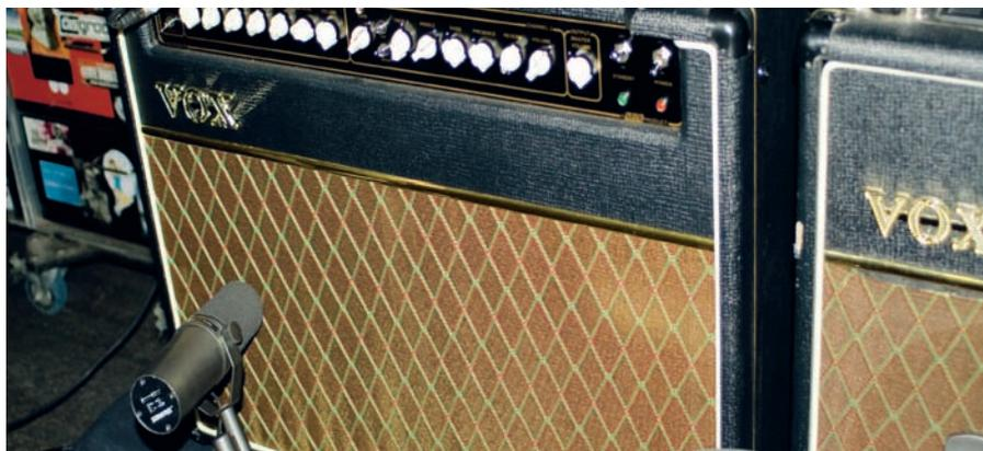
Schiebt das Mikro bis zur Bespannung der Box, so ist ein Minimum an Übersprechen anderer Signale gewährleistet.
