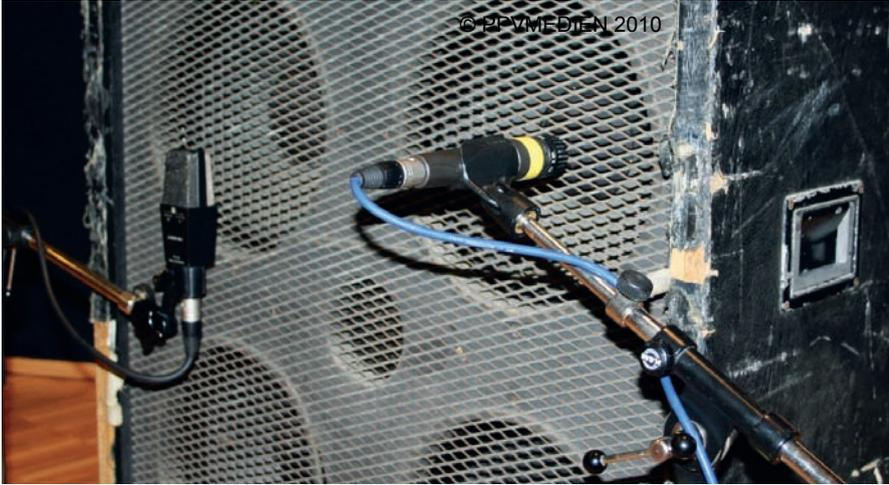
Wenn zwei Mikros nah am Speaker eingesetzt werden, ist es Möglich ein höhen- und tiefenlastiges Signal aufzuzeichnen.
