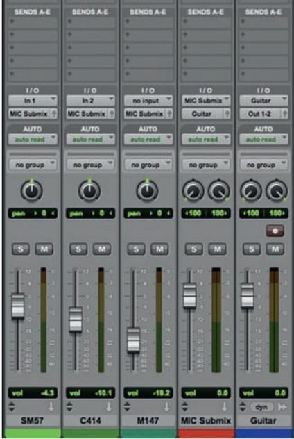
Mögliches Routing einer E-Gitarren-Multimikrofonierung in Pro Tools.
