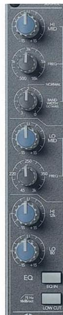
**Klangregelung des Mackie 8-Bus Pultes:** Von oben nach unten angeordnet sind ein vollparametrischer Mittenregler (HI MID), ein semiparametrischer Equalizer (LO MID), der High- und der Low-Shelve sowie das Trittschallfilter.
