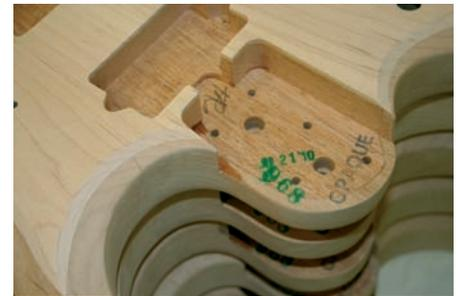
Die Instrumente werden in der Hals-Fräsung datiert
