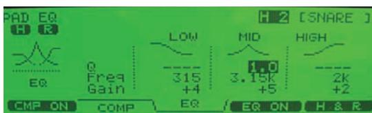
Abb. 5: Equalizer, kurz EQ genannt, heben und senken bestimmte Frequenzbereiche.
