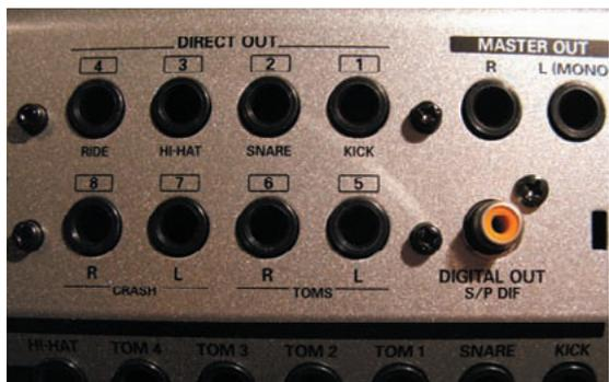
Abb. 2: Teure Soundmodule bieten neben dem Summenausgang („Master Out“) auch Einzelausgänge.
