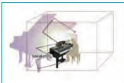
Yamaha nimmt bei der iAFC-Technik den Schall im Raum durch ein Mikrofon auf und gibt die Signale über eigene Speaker aus.
