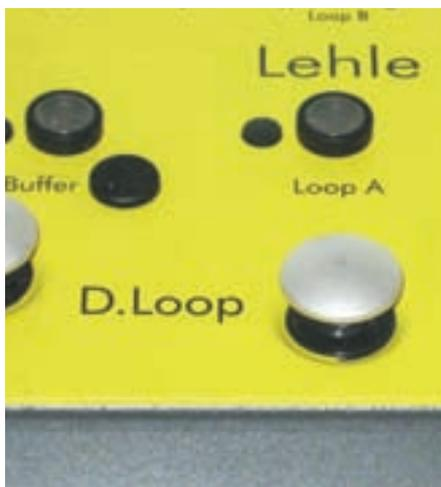
Eine Loop-Box ermöglicht den fliegenden Preamp-Wechsel
