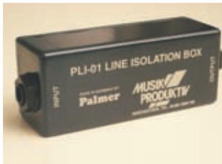
Bei Brummschleifen hilft eine Isolation-Box
