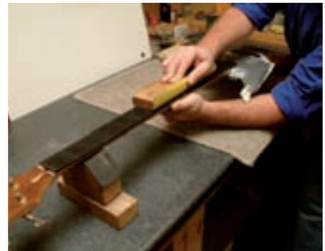
**Abb. 6:** Schleifen des Griffbretts
