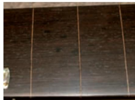
**Abb. 19:** Griffbrett fertig geschliffen und poliert
