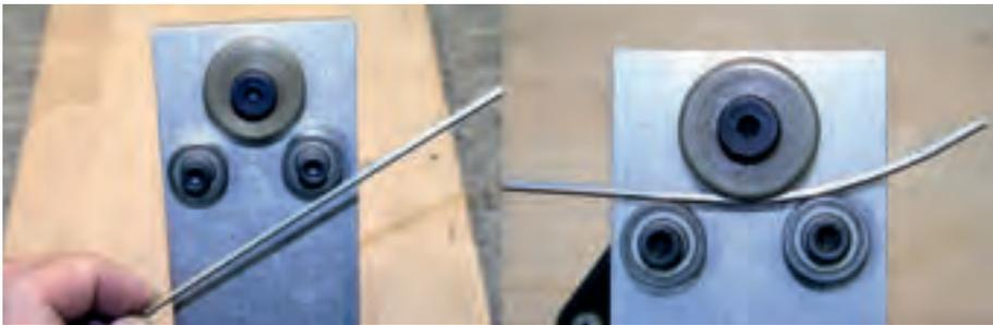
Abb. 5: Aus gerade wird krumm: das Biegen des geraden Rohmaterials mit dem Fretbender
