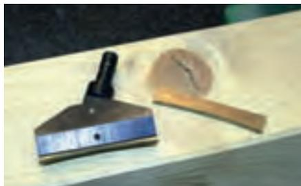
Abb. 8: So klappt's auch mit dem widerspenstigen Edelstahl: beweglicher Stempel mit Einsatz ...
