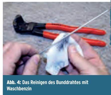
Abb. 4: Das Reinigen des Bunddrahtes mit Waschbenzin
