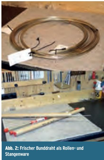
Abb. 2: Frischer Bunddraht als Rollen- und Stangenware
