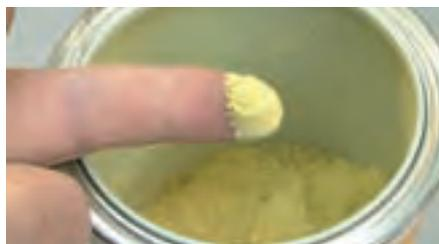
Abb. 2: Porenfüllpulver erhöht den Festkörperanteil beim Lackaufbau
