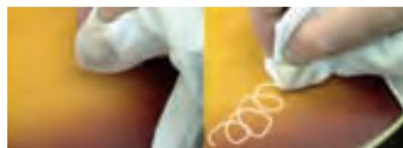
Abb. 8: Eine Geduldssprobe: das Aufpolieren einer Fläche von Hand
