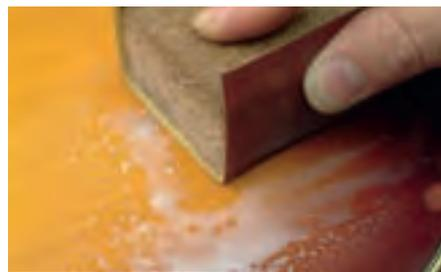
Abb. 7: Nassschliff einer fertig lackierten Oberfläche
