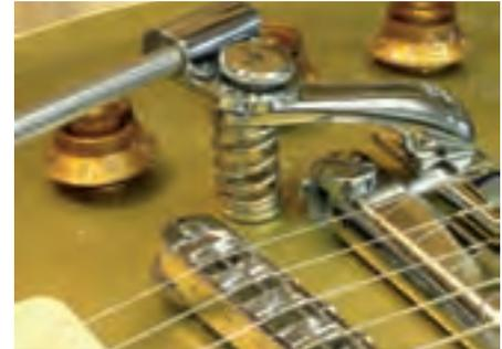
**Abb. 12:** Sorgt für den Gegendruck: die Feder im Bigsby-Style
