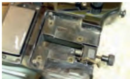
Abb. 1: Die Korpusfräsung für das Steinberger-System
