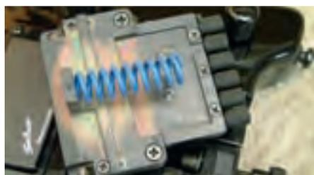
Abb. 2: Die Unterseite des Systems mit der Druckfeder
