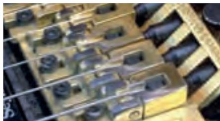
Abb. 1: Verbrauchtes Material: intensiv genutztes Floyd-Rose-System
