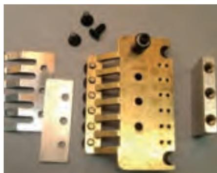
**Abb. 11:** Das Floyd in Einzelteilen
