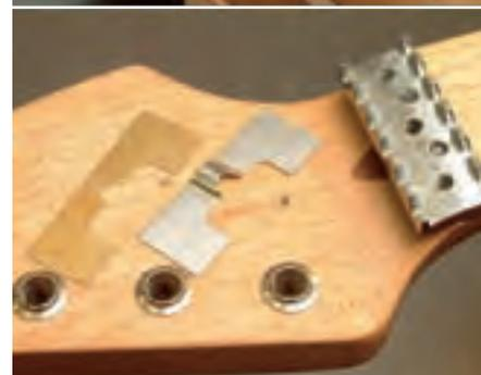
**Abb. 13:** Anpassen des Klemmsattels
