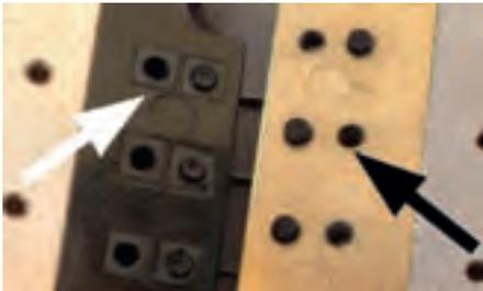
Abb. 6: Gehärtete Einsätze geben der Schraube mehr Halt
