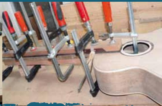
Der Tendenz zu einteiligen Hälsen zum Trotz schäftet Dreizehnter die Kopfplatte an, was zu einer stabileren Verbindung führt (links). Traditionell ist auch die Methode, das Binding zu verleimen. Um den notwendigen Druck zu erreichen, wird der Korpus komplett eingewickelt (Mitte). Dagegen werden beim Verleimen des Griffbretts Schraubzwingen benutzt (rechts)
