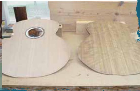
Elemente eines akustischen Instruments: Der Korpus besteht aus einer Decke und einem Boden, die durch gebogene Zargen – der Biegeprozess ist im mittleren Bild zu sehen – auseinandergehalten werden. Damit Decke und Boden auch auf dem Zargenkranz aufgeleimt werden können, werden sogenannte Reifchen eingeleimt (links)
