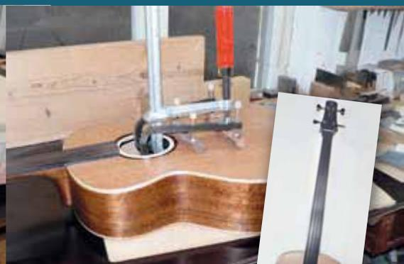
Nun muss nur noch der Hals fertig geformt werden, dann kann das Instrument für die Lackierung vorbereitet werden. Abschließender Arbeitsschritt vor dem eigentlichen Setup ist das Verleimen des Stegs (rechts)
