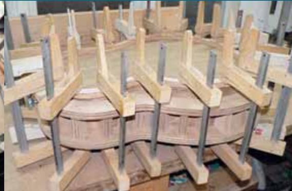
In Dreizehnters Werkstatt geht es erfrischend traditionell zu. Die Leisten des Bracings werden mit Hilfsleisten auf die Decke gepresst, während der Leim trocknet (links). Der Zargenkranz verbleibt in der Form, auch nachdem die Decke aufgeleimt ist (Mitte), und zwar so lang, bis der Korpus völlig geschlossen ist (rechts)
