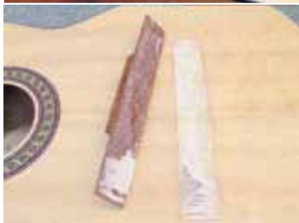
Abb. 1: Materialermüdung führt häufig zum Ablösen des Stegs
