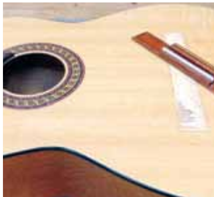
Abb. 2: Die gesplitterte Schadstelle verhindert eine saubere Verleimung
