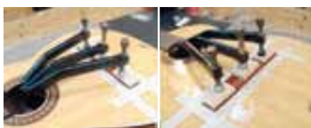
Abb. 8: Zwingen fixieren den Steg beim Verkleben
