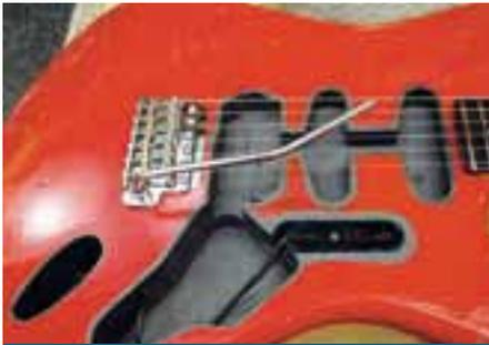
**Abb. 4:** Das mit leitendem Lack ausgekleidete E-Fach, um elektrische Einstreuungen abzuleiten
