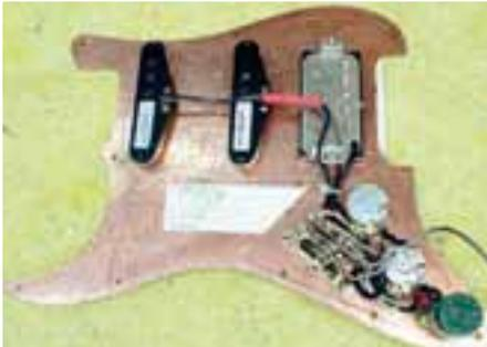
**Abb. 5:** Metallfolie auf der Unterseite des Schlagbrettes macht die Abschirmung komplett
