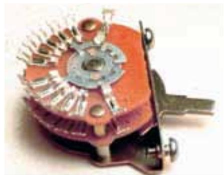
**Abb. 7:** Mittelpunkt der Schaltung: der Megaswitch
