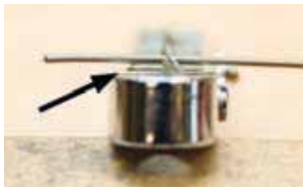
Abb. 4: Schepperfalle: der zu tief gefressene Einzelreiter
