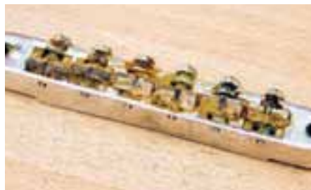
Abb. 2: Used and abused: völlig verbrauchter Gitarrensteg
