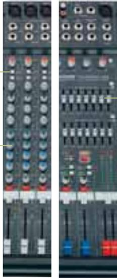
**Der Kanal-EQ ist nicht nur da, um Problemfrequenzen auszumerzen, hier darf auch betont werden. Praktisch sind halbparametrische Mitten, bei denen die Einsatzfrequenz und die Verstärkung eingestellt werden können.**
