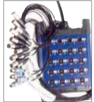
Auch schon auf kleineren Bühnen sorgen Stageboxen und Multicore-Kabel für eine aufgeräumte Optik und reduzierte Stolperfallen.
