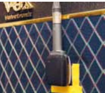
Damit Sie den einmal gefundenen Idealsound beim Abnehmen eines Gitarren-Amps reproduzieren können, markieren Sie die Mikrofonposition mit Klebeband.
