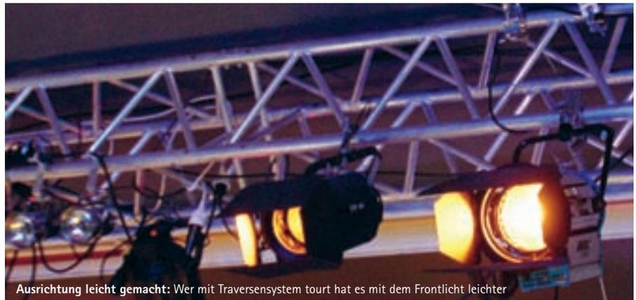
Ausrichtung leicht gemacht: Wer mit Traversensystem touert hat es mit dem Frontlicht leichter
