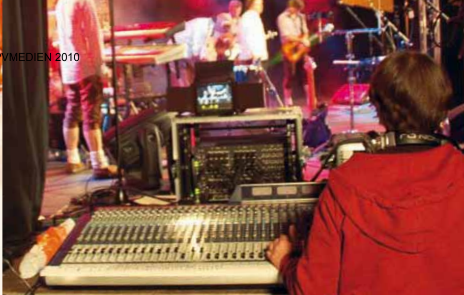
Analog schlägt digital: Der Monitormix wurde mit einem Soundcraft GB 8 gefahren. Dieses analoge Pult war vorteilhaft, da es den Technikern einen um entscheidende Sekunden schnelleren Zugriff erlaubte. Zudem waren keine Setups abzuspeichern.
