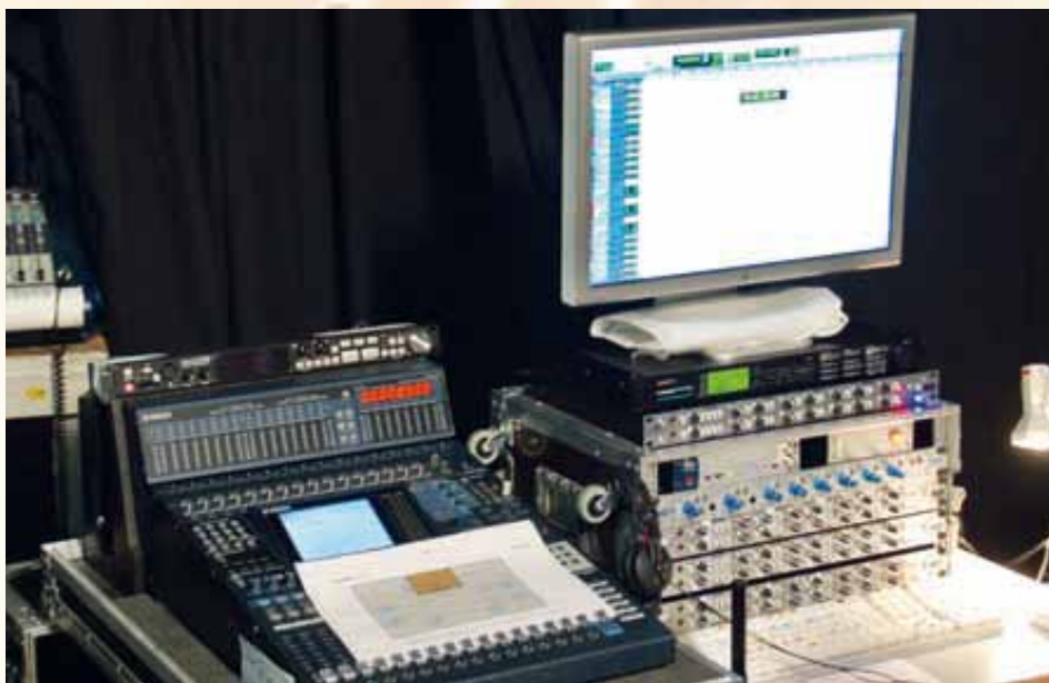
Großes Besteck: Tontechnisch wurde auf 48 Kanälen aufgezeichnet. Als Beschallungspult fürs Studio kam ein Soundcraft SI1 zum Einsatz, als Backup diente ein Yamaha LS 9-32.
