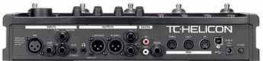
Viefältige Anschlussmöglichkeiten bietet die Rückseite des Bodentreeters: Berücksichtigt werden analoge und digitale Signale, sowie eine USB-Verbindung für Updates.
