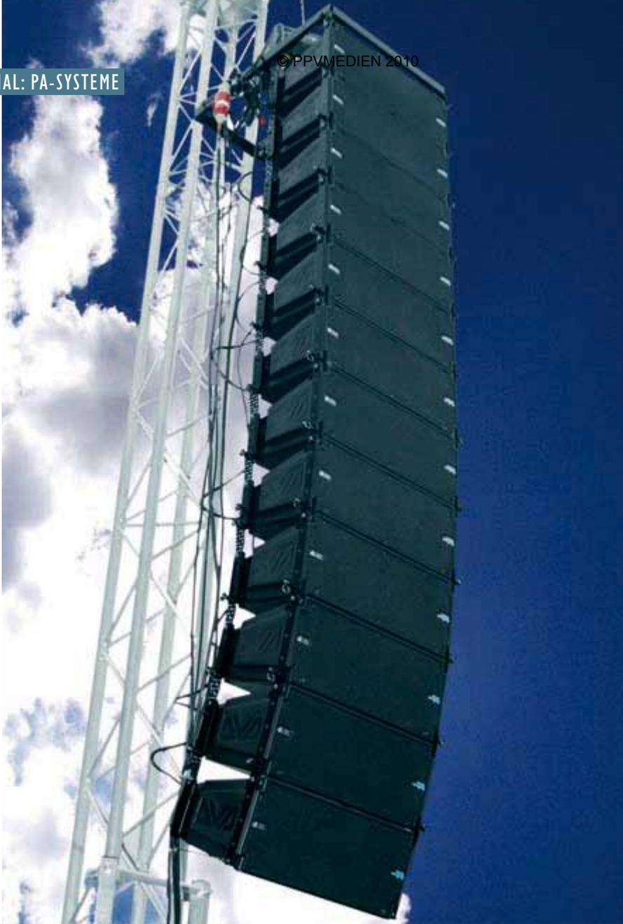
Line Arrays werden bevorzugt auf „Open Air“-Konzerten eingesetzt, da hierbei eine größere und vor allem gleichmäßigere Schallabstrahlung zu realisieren ist: dB Technologies DVA
