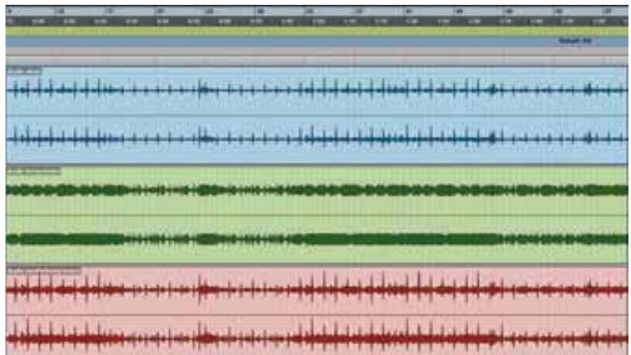
**An den Wellenformen werden die Auswirkungen der Parallelen Bearbeitung deutlich:** Oben ein unbearbeitetes Signal. In der Mitte die Darstellung des bis zur Unkenntlichkeit komprimierten Parallelsignals. Unten schließlich die Mischung der beiden Signale – die Transienten bleiben erhalten, aber man erkennt die Veränderung besonders in den Peakzwischenräumen.
