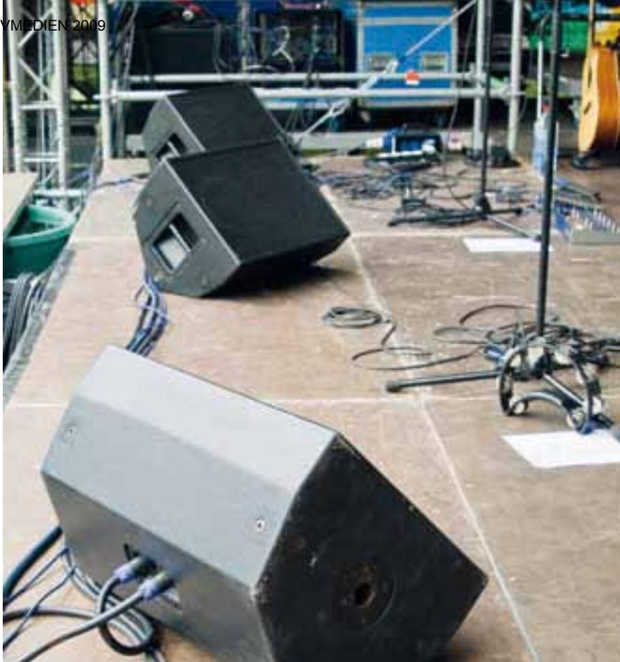
**Richtcharakteristik beachten:** Bei Hyper- oder Supernierenmikros müssen die Wedges schräg von hinten auf die Kapsel
