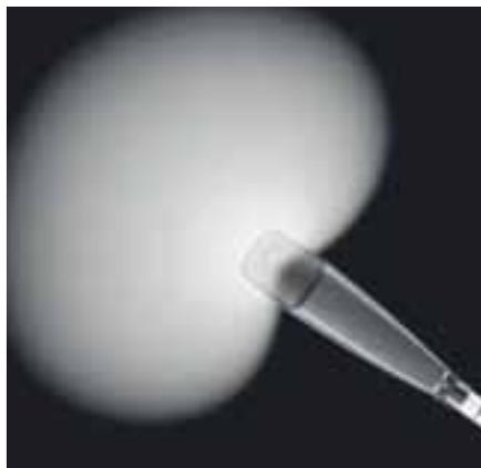
**Richtcharakteristik:** Die Niere bedämpft Störerschall direkt hinter der Kapsel am besten ...
