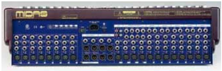
Falls die Monitorwege mal knapp werden, kann über die Direct Outs ein weiteres (Monitor)-Pult angeschlossen werden: Midas Venice 240
