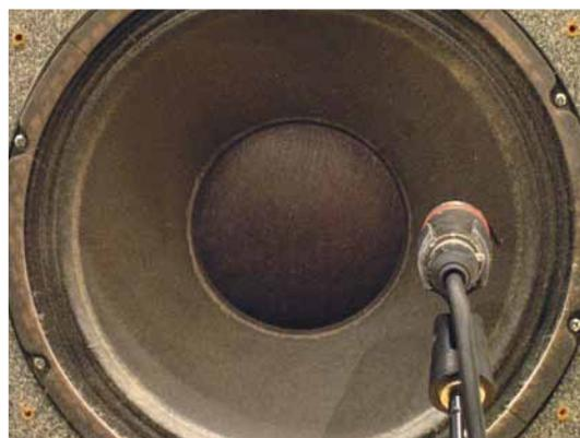
**Amp-Abnahme mit Shure SM57:** Berücksichtigt ganz explizit, dass auch der Ausrichtungswinkel des Mikrofons den Sound beeinflusst.
