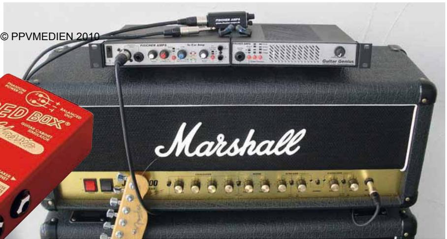
Die Red Box von Hughes & Kettner ermöglicht ebenso wie der Guitar Genius von Fischer Amps leises Gitarrenspiel: Mit ihnen kann ein Gitarrenamp auch in leisem Betrieb über der Endstufensättigungs-Schwelle betrieben werden. Der Sound klingt also genauso druckvoll wie bei hoher Lautstärke.
