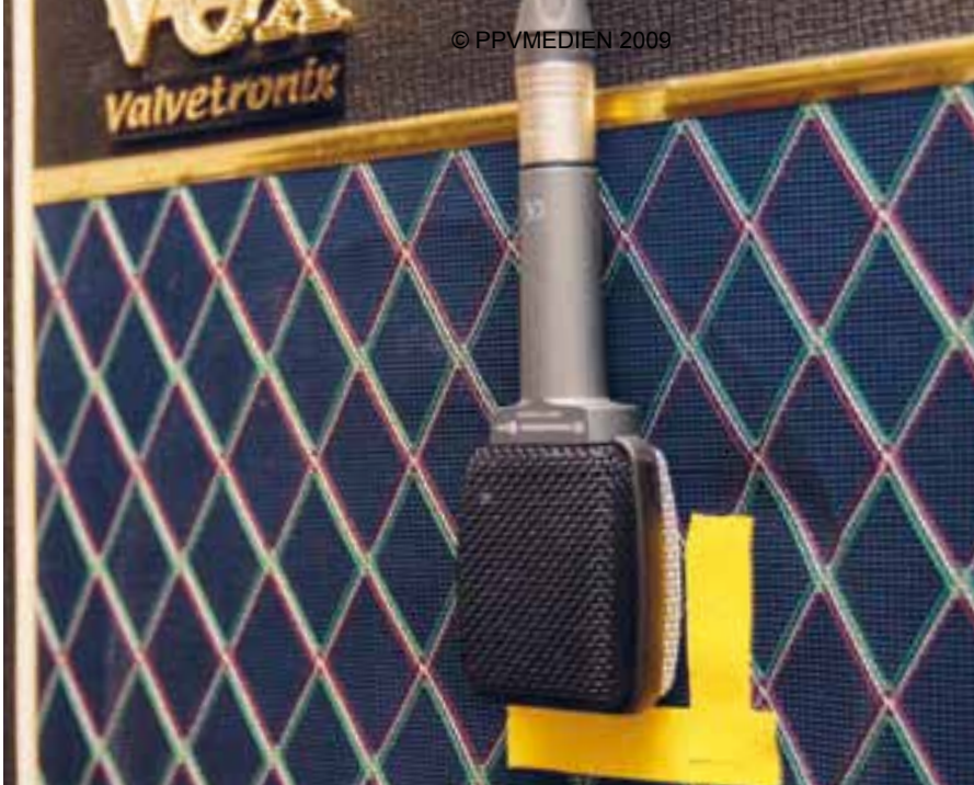
Wenn der Sweet Spot eures Gitarrenspeakers gefunden wurde, könnt ihr den einfach mit Klebeband markieren.
