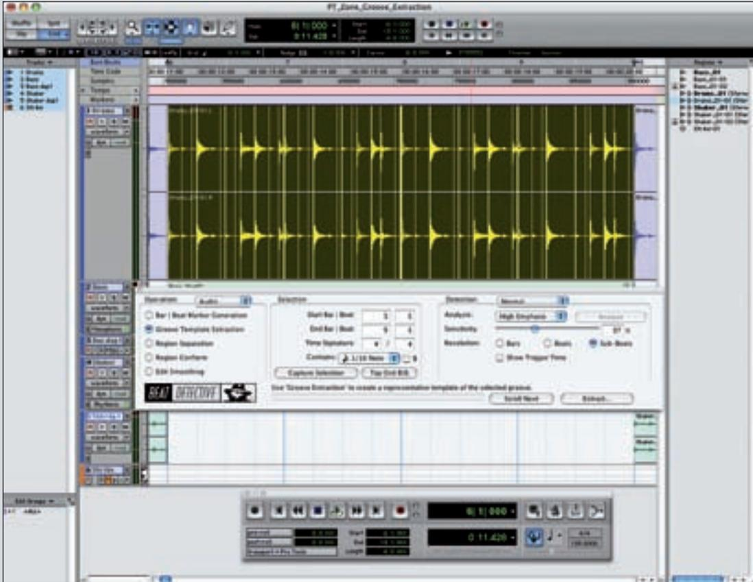
Der Beat Detective ist durch Elastic Time in Pro Tools 7.4 nicht überflüssig geworden – im Gegenteil: Man kann beide Funktionen sinnvoll kombinieren
