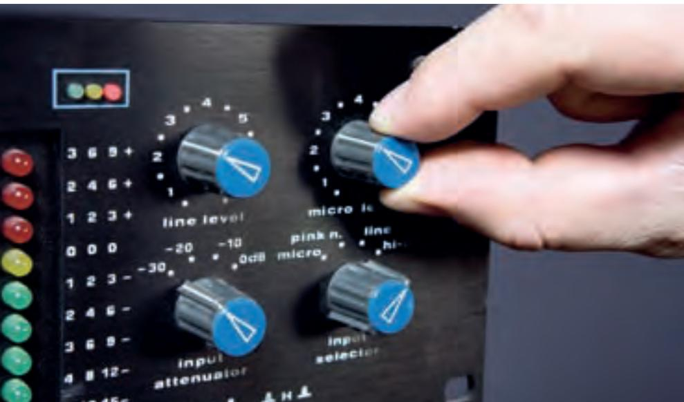
**Damit man einem Analyserdisplay sinnvolle Werte entnehmen kann, muss man das Gerät natürlich vorher auf den jeweiligen Bezugspegel kalibrieren.**
