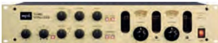
Der Tube Vitalizer von SPL verstärkt als Enhancer die vorhandenen Obertöne eines Audiosignals. Daneben hat er noch einen Kompressor, einen EQ sowie eine Röhrenausgangsstufe an Bord.
