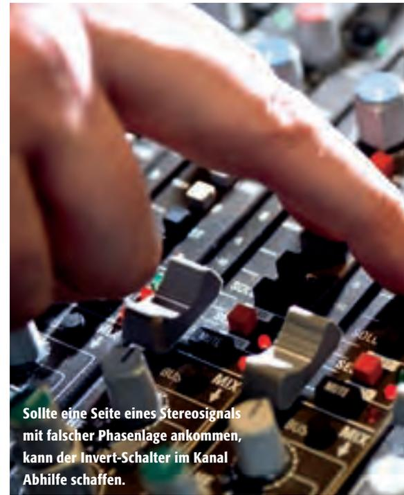
**Sollte eine Seite eines Stereosignals mit falscher Phasenlage ankommen, kann der Invert-Schalter im Kanal Abhilfe schaffen.**
