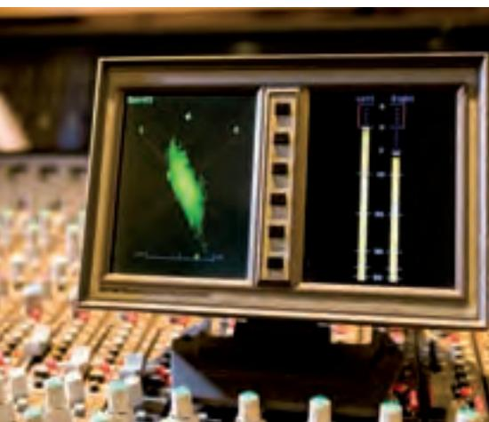
**Oben sieht man ein monokompatibles Stereosignal, unten wurde der Inputgain im rechten Kanal nicht weit genug aufgedreht, so hängt das Stereosignal nach links.**
