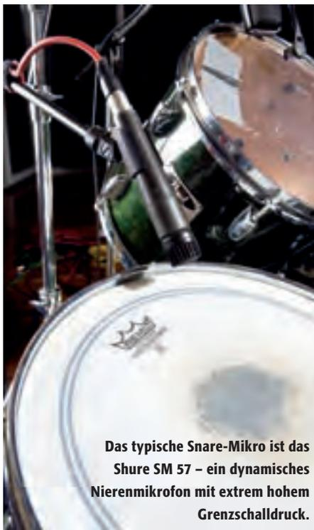
Das typische Snare-Mikro ist das Shure SM 57 – ein dynamisches Nierenmikrofon mit extrem hohem Grenzschalldruck.
