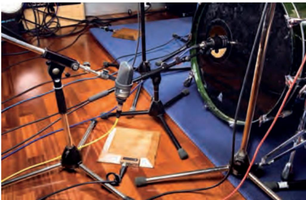
**Für die Abnahme der Bassdrum gibt es neben dem klassischen Mikro im Resonanzfell-Loch noch andere Varianten, wie die Abnahme mit einer Grenzfläche oder einem Großmembrankondensator außerhalb des Kessels.**
