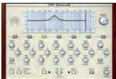
Der Bell-Filter bearbeitet die Frequenzen um die Mittenfrequenz. Seine Kurve ähnelt deutlich dem Bild einer Glocke.
