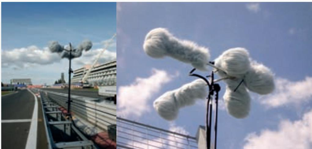
**Mikrofonierung nach INA-5 am Nürburgring, realisiert mit Atmos 5.1-Systemen von SPL.** (links: an der Boxengasse)
