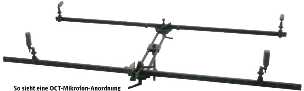
So sieht eine OCT-Mikrofon-Anordnung der Firma Schoeps in der Realität aus.
