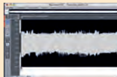
Eine Spur einer verzerrten Gitarre. Auch hier ist das Signal eher wenig dynamisch.
