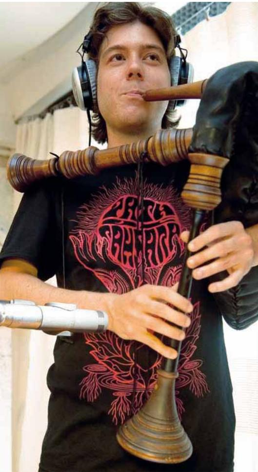
**Für Dudelsackaufnahmen werden gerne Kleinmembran-Kondensatormikrofone verwendet. Ihre natürliche Obertonabbildung wird dabei sehr geschätzt. Hier ist das in Hochfrequenztechnik arbeitende Sennheiser MKH 8040 zu sehen. Es überträgt Frequenzen bis zu 50.000 Hz.**
