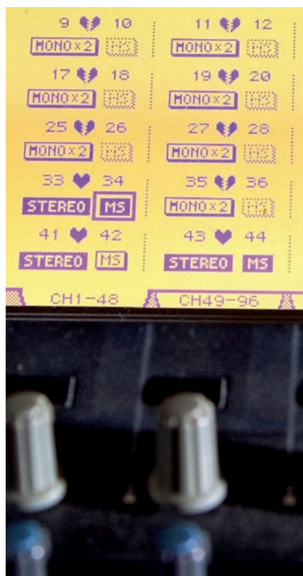
Einige Digitalpulte bieten neben der Stereokanalgruppierung die Möglichkeit zur direkten M/S-Decodierung.
