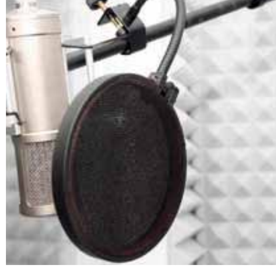
Der Poppschutz verhindert nicht nur Explosivlaute, sondern hält den Sänger auf Abstand.
