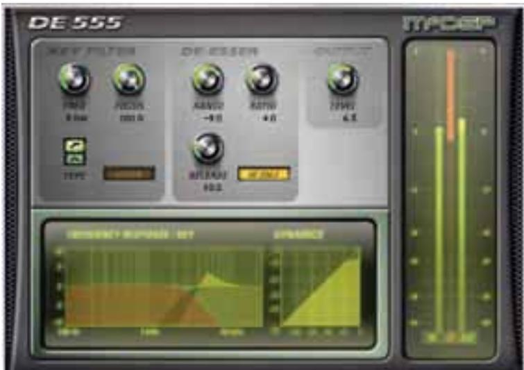
**Der De-Esser DE 555 von McDSP bedämpft die Zischlautfrequenzen, die in einem Bereich von etwa 5 bis 8 kHz liegen. Der DE555 erlaubt es, das Frequenzband, das bedämpft werden soll über den Key Filter genau einzustellen und abzuhören.**
