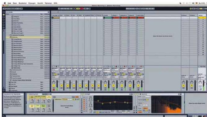
**Bild 6:** Die Summenbearbeitung erfolgt in Ableton Live über die Master Effect Racks. Hierbei stehen eine Vielzahl an internen Effekten zur Verfügung.
