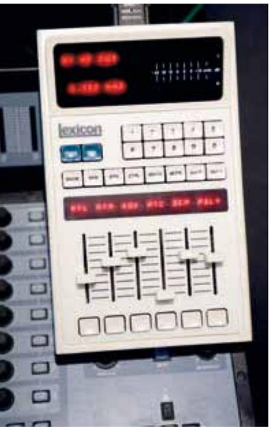
**Der Edelhallklassiker Lexicon 480L besteht aus einem 19-Zoll-Modul und der hier sichtbaren Fernbedienung LARC (Lexicon Alphanumeric Remote Control).**
