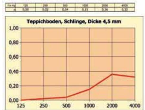
Das Absorptionsdiagramm gibt einen schnellen Überblick über die Absorption des Bauteils in Terzen oder Oktaven.
